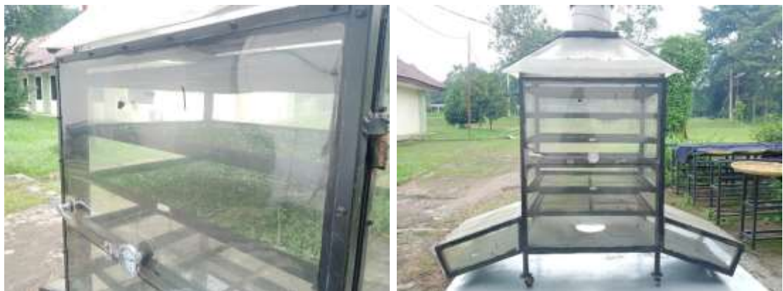
Gambar 2. Proses pengeringan daun kelor menggunakan blower matahari
