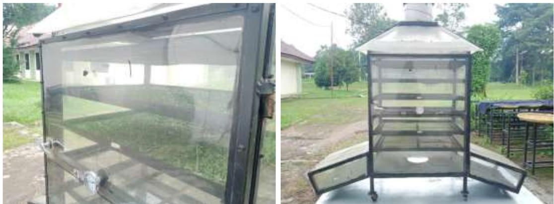
Gambar 2. Proses pengeringan daun kelor menggunakan blower matahari
