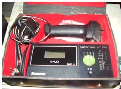
Figure 1. Lignometer HT100-moisture meter used in the experiment ( Gambar 1. Moisture meter tipe Lignometer HT100 yang digunakan dalam penelitian )
