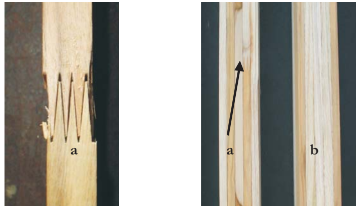
Gambar 3. Profil balok lamina dirakit dari lamina JPP dengan sambungan berbentuk jari (a) dan tanpa sambungan (b)
